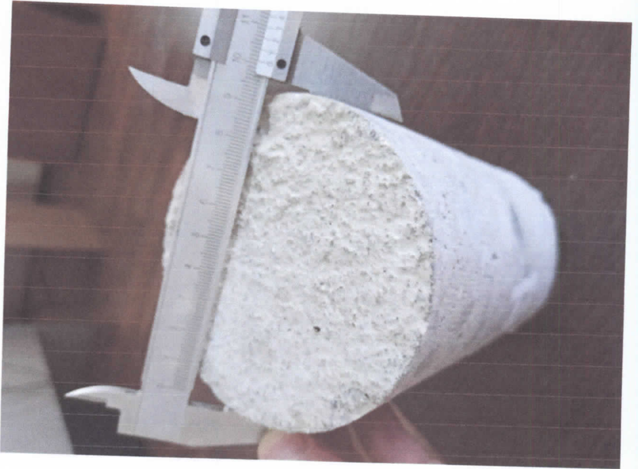
При незначительном воздействии образец расслаивается.
