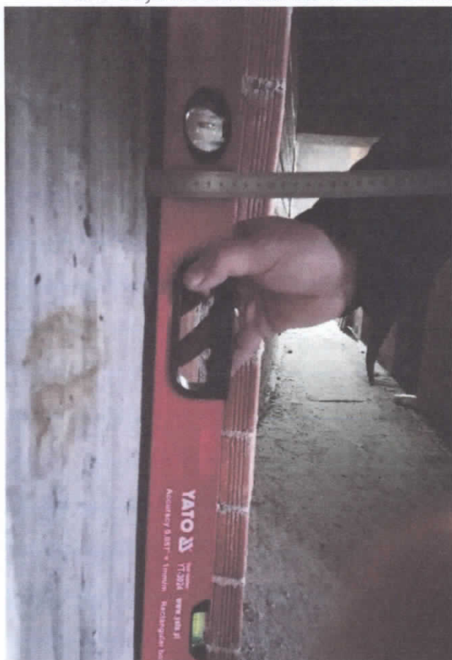
Фото 23,24.Отклонение стены от вертикали до 30мм
